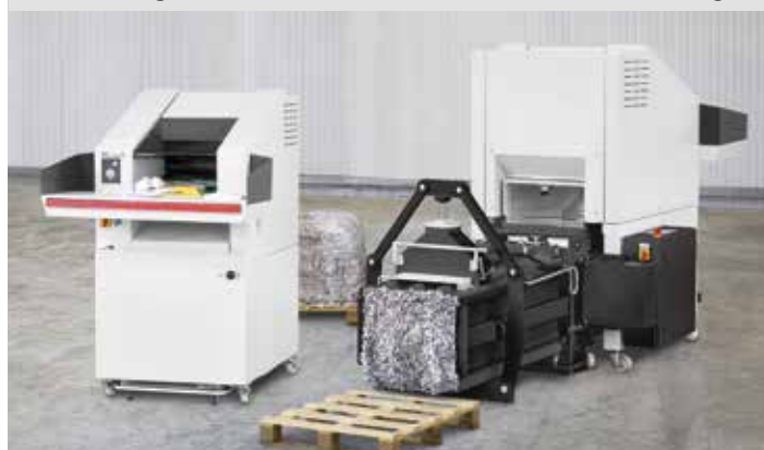
HSM Powerline: Großmengen-Aktenvernichter für die zentrale Vernichtung.
