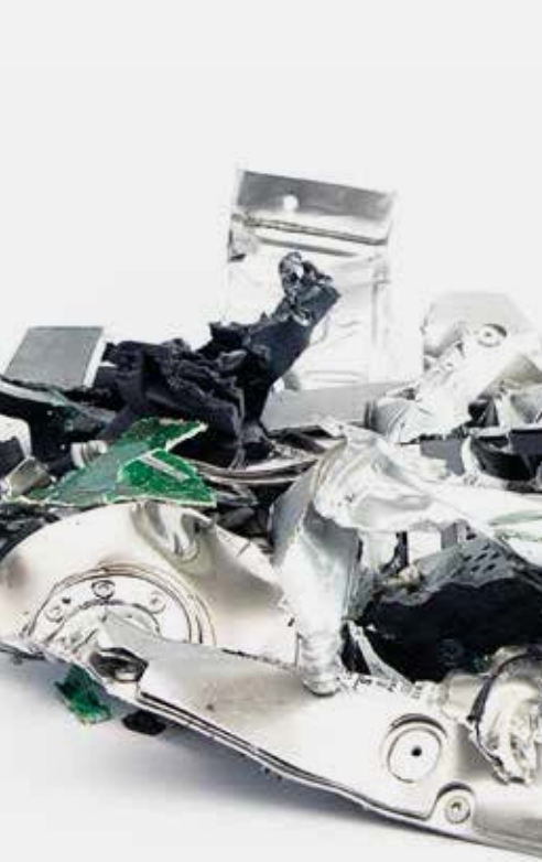
Festplatte vernichtet mit dem HSM StoreEx HDS 150 in der Sicherheitsstufe H-3.
