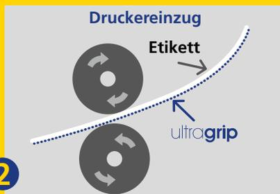
**2** Durch diese Angriffsfläche können die Druckerwalzen den Bogen noch besser greifen, einziehen und führen.
