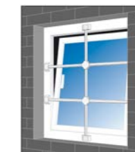
Montage auf dem Fensterbänke
