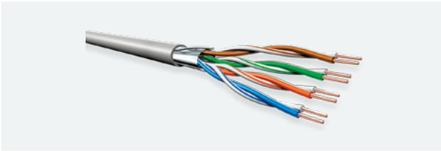
**F/UTP:** engl. foil screened unshielded twisted pair; Gesamtschirm aus metallisierter Folie, kein Paarschirm; in der Praxis auch als FTP-Kabel bezeichnet
