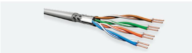
**SF/UTP:** engl. braid and foil screened unshielded twisted pair; Gesamtschirm aus metallisierter Folie und Geflecht, kein Paarschirm
