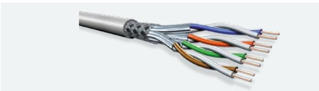
**SF/FTP:** engl. braid screened shielded twisted pair; Gesamtschirm aus Geflecht, Aderpaare einzeln mit Folienschirm versehen. Häufigste Bauform geschirmter Leitungen, in der Praxis auch als PIMF (Paare in Metall-Folie) bezeichnet
