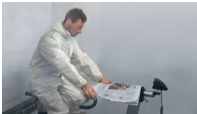
Messung über 10 Sensoren auf der Brust und 14 auf dem Rücken.
