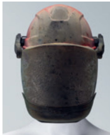
Nach 7 kA Störlichtbogen
