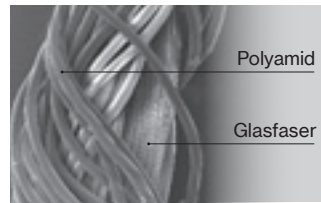
Guter Aufbau: Kern – Mantel – Garn.
