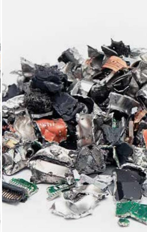
Disques durs détruits avec le destructeur de supports de données numériques HSM StoreEx HDS 230 (deux vitesses), degré de sécurité H-5.
