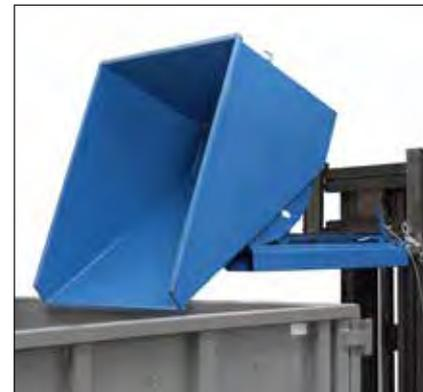
Selbstkipper als Schrottbehälter mit Gabelstapler
