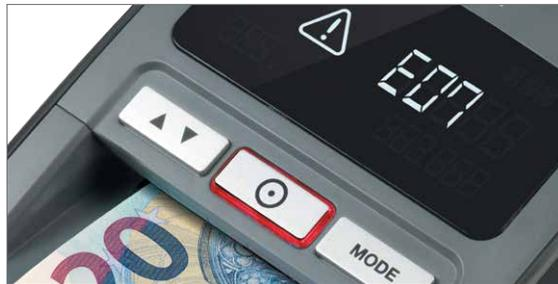
Alarme lorsqu'un billet suspect est détecté
