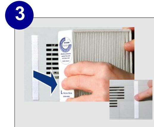
Nehmen Sie den Filter vorsichtig ab und drücken Sie den am Gerät verbleibenden Klettstreifen noch einmal gut an. Den Filter wieder am Gerät befestigen.
